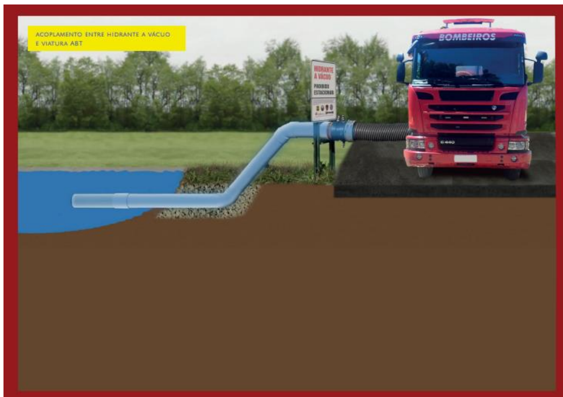
Figura 1 – Hidrante à vácuo atrelado a introdução principal da bomba de combate ao incêndio da viatura ABT.
