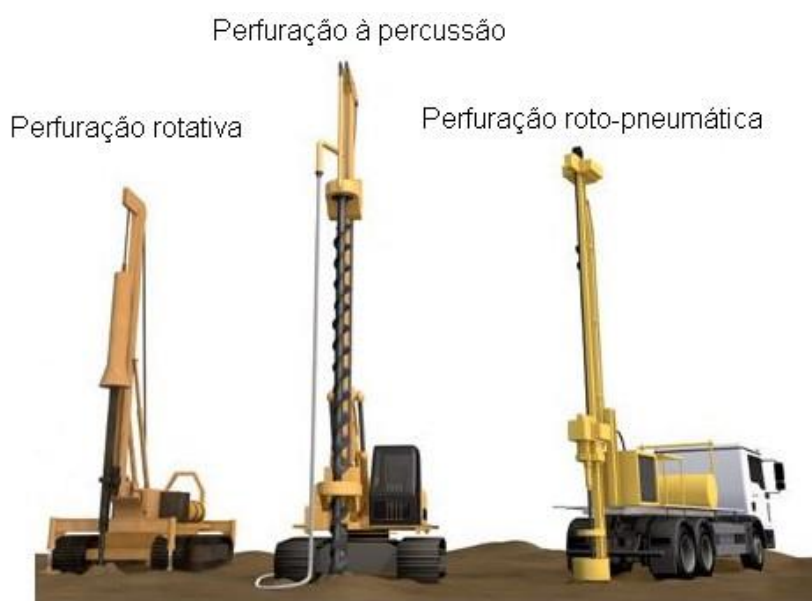
Figura 8 – Tipos de perfuratrizes. Fonte: MB Geologia e Meio Ambiente (2023) 3 .
