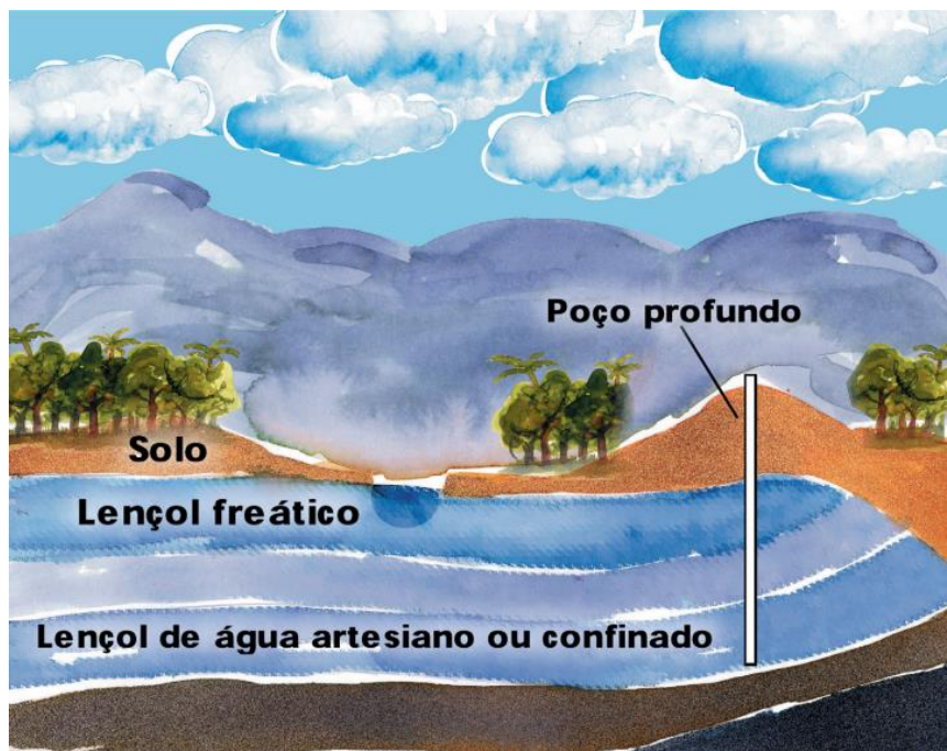
Figura 7 – Poço tubular profundo. Fonte: FUNASA (2008).
