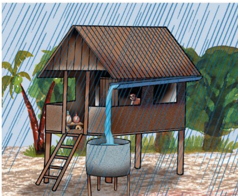
Figura 3 – Cisternas armazenando a água da chuva. Fonte: FUNASA (2008).
