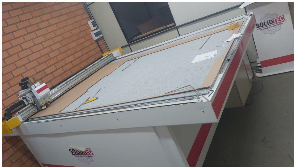
Figura 3 - Equipamento utilizado para o corte do papelão. Fonte: De autoria própria, 2022.
