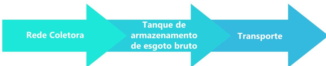
Figura 7 – Configuração sistema centralizado parcial
