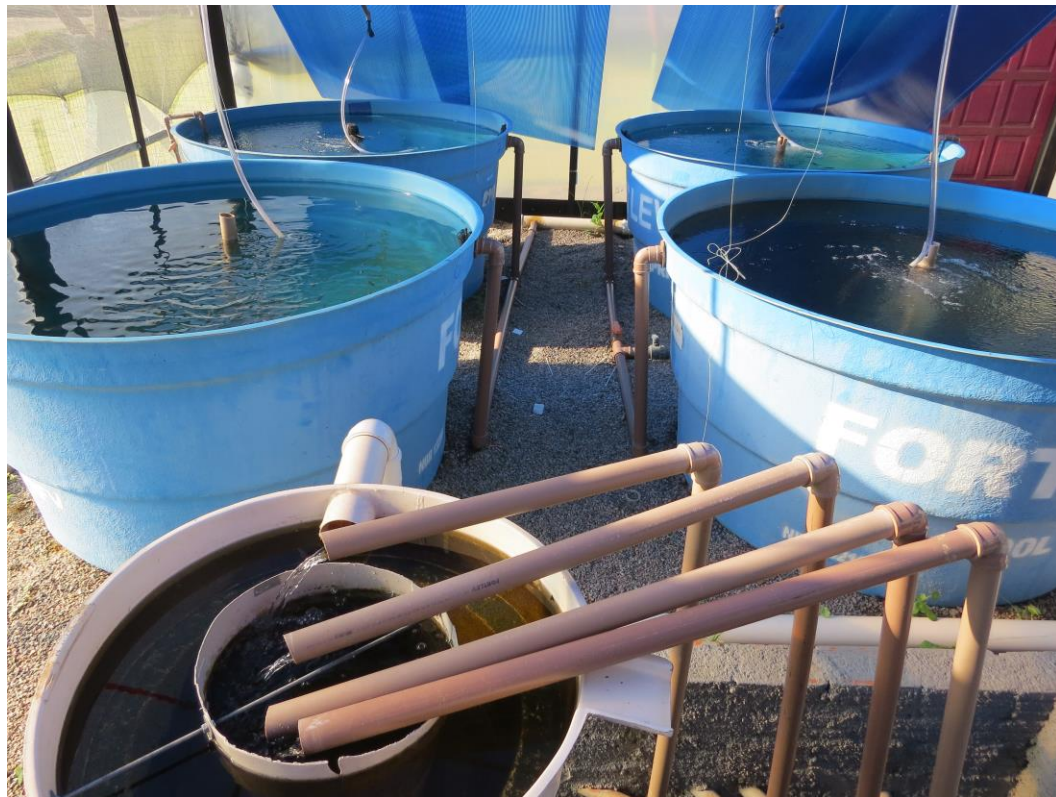
Fig. 1 Sistema de recirculação de água do Laboratório de Aquicultura (LAQ) da UDESC/Laguna.
