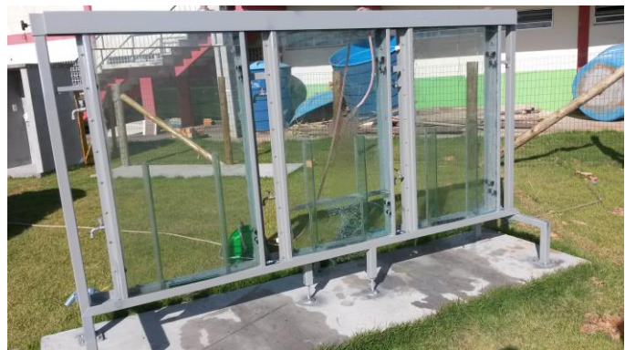
Fig. 4 Atuais fotobiorreatores planos do LCBA
