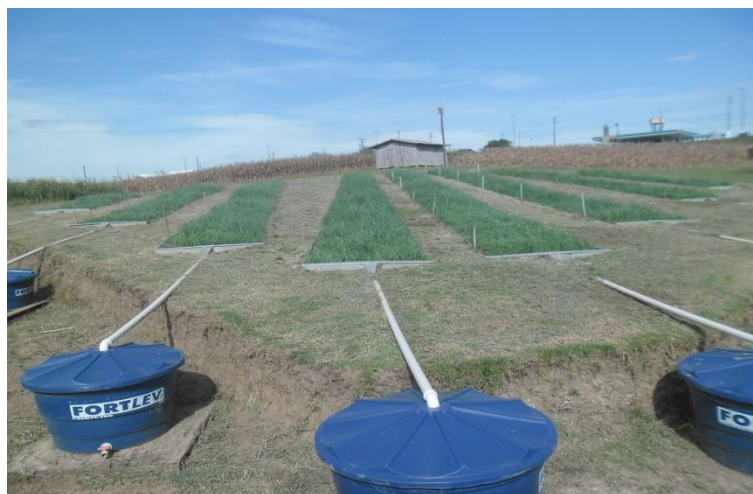
Fig. 1 Representação das unidades experimentais com os respectivos tanques que armazenam a enxurrada.
