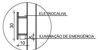
DETALHE CAIXA PASSAGEM ENERGIA 1o. PAVTO.
