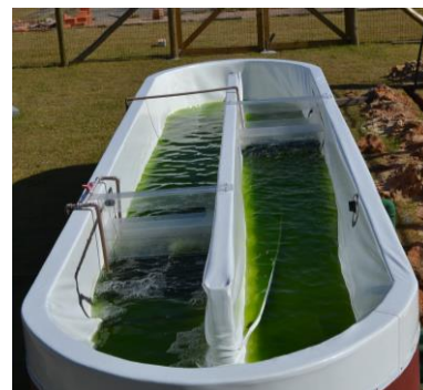
Fig. 2 Cultivo de Chlorella sp. em tanque “raceway” Tese de produção em escala massiva.
